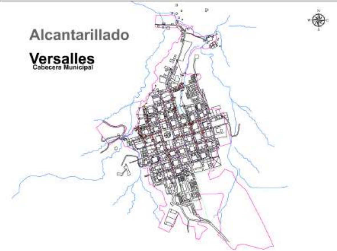
Figura 72 Alcantarillado Casco Urbano Versalles
